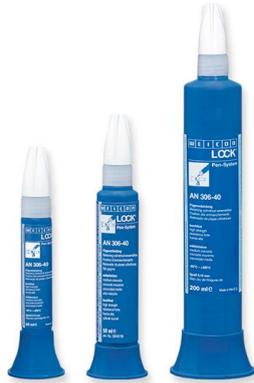
**WEICONLOCK® AN 306-40** предназначен для фиксации цилиндрических узлов размером до М 20, где необходима высокая прочность при высоких рабочих температурах. Демонтаж этого герметика можно произвести только после предварительного нагрева до +350°С.
