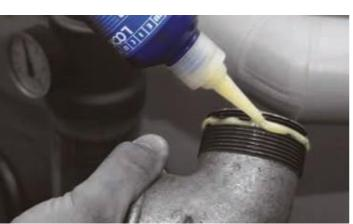
AN 302-43 — высококачественный анаэробный клей и герметик, предназначенный для экономичной фиксации, закрепления и герметизации всех видов резьбовых соединений.
