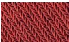
Структура ткани с нанесенным абразивом
