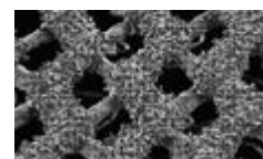
Структура полиамидной сетки с нанесенным абразивом
