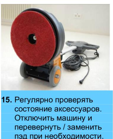
15. Регулярно проверять состояние аксессуаров. Отключить машину и перевернуть / заменить пэд при необходимости.
