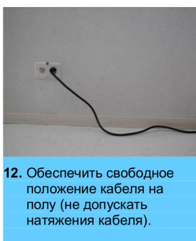
12. Обеспечить свободное положение кабеля на полу (не допускать натяжения кабеля).
