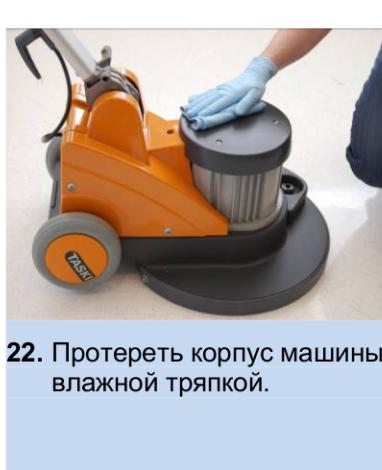
22. Протереть корпус машины влажной тряпкой.
