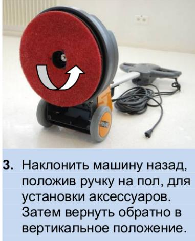
3. Наклонить машину назад, положив ручку на пол, для установки аксессуаров. Затем вернуть обратно в вертикальное положение.
