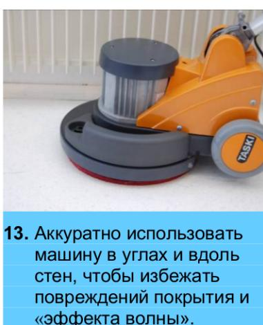
13. Аккуратно использовать машину в углах и вдоль стен, чтобы избежать повреждений покрытия и «эффекта волн».
