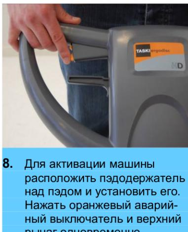
8. Для активации машины расположить пэдодержатель над пэдом и установить его. Нажать оранжевый аварийный выключатель и верхний рычаг одновременно.
