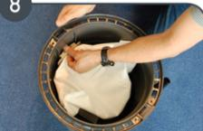
Зафиксировать мешок. Проверить шланги на отсутствие засорения.
