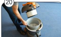
Дополнительно: Использовать на TASKI Vento 15S микрофильтр (HEPA) для улучшения качества воздуха.
