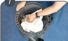
Установить картонный фланец в пазы и слегка нажать на него для фиксации фильтра.
