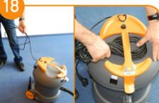
Отключенный от розетки кабель наматывать обратно на ручку, протирая его при этом влажной тряпкой.
