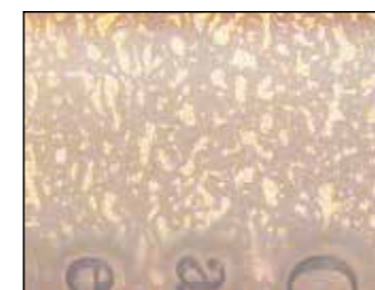
Лайнер с неоднородной поверхностью
